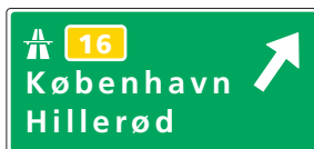
I 16: Frakørselsvejviser 0 m tavle for forbindelses-anlæg til anden motorvej.
